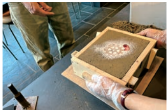
木枠の中に隙間なく砂を詰めていく
