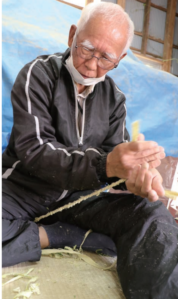
削った真竹の皮を、一定の太さでより合わせる。
