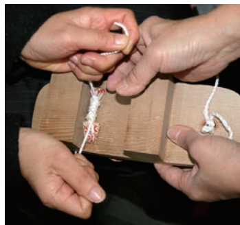
左右の鼻緒の紐をぐるぐる巻きにする。「くじり」を使って鼻緒の紐を縛る。
