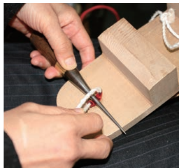
左右の鼻緒の紐をぐるぐる巻きにする。「くじり」を使って鼻緒の紐を縛る。
