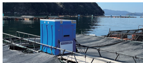
同社製品：UMITRON CELL (AI搭載型自動給餌機)
